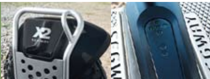
справа | Приборная панель снимается и превращается в пульт дистанционного управления. Удобно для обучения: инструктор может удалённо включать нужный режим и глушить мотор в экстренной ситуации
