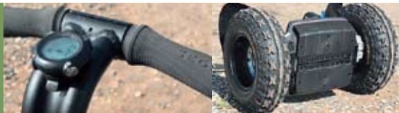
справа | Приборная панель снимается и превращается в пульт дистанционного управления. Удобно для обучения: инструктор может удалённо включать нужный режим и глушить мотор в экстренной ситуации
